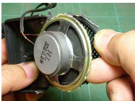
スピーカーフレームの端を持ち上げながら剥がします。
